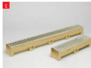
Канал ACO Self® Euroline длиной 1 м и 0,5 м из полимербетона с решеткой из оцинкованной стали
