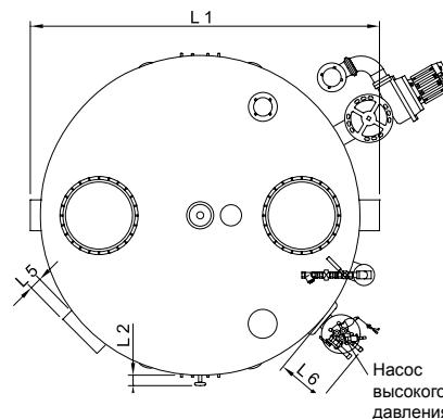
На изображении показан сепаратор номиналом 7л/с, обслуживаемый справа. При левостороннем обслуживании все элементы будут расположены в зеркальном отражении.
