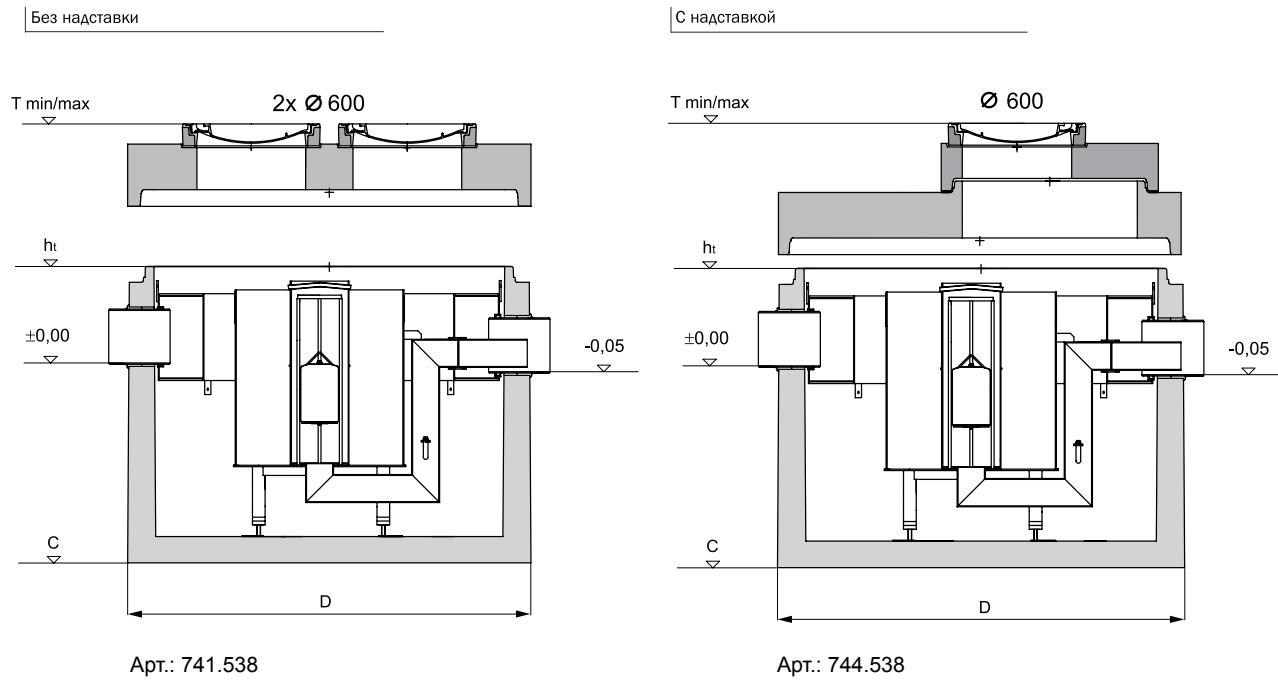
**T<sub>min</sub>** – минимальная глубина установки сепаратора по лотку трубы
