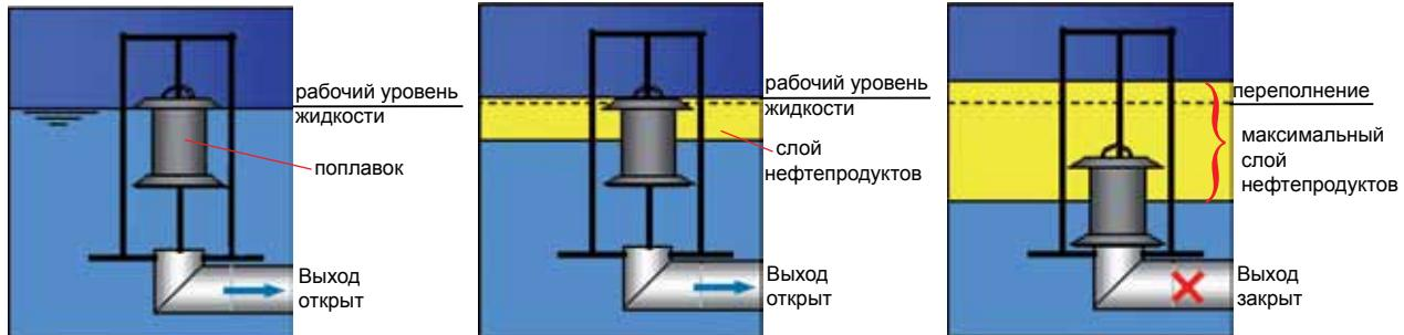
Стартовое положение поплавка (при запуске в эксплуатацию или после очистки сепараторов).
