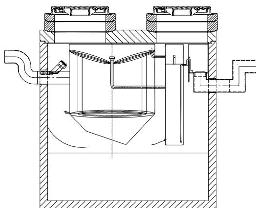
Сепараторы нефтепродуктов ACO Oleotop® и Oleotop® Plus – это новинки от лидера рынка водоотвода и водоочистки. Это совершенно новый подход к очистке дождевых поверхностных вод. Благодаря уникальному техническому решению вода очищается уже на входе в сепаратор, освобождаясь от примесей и нефтепродуктов в вихревом потоке. Степень очистки при этом улучшается.
