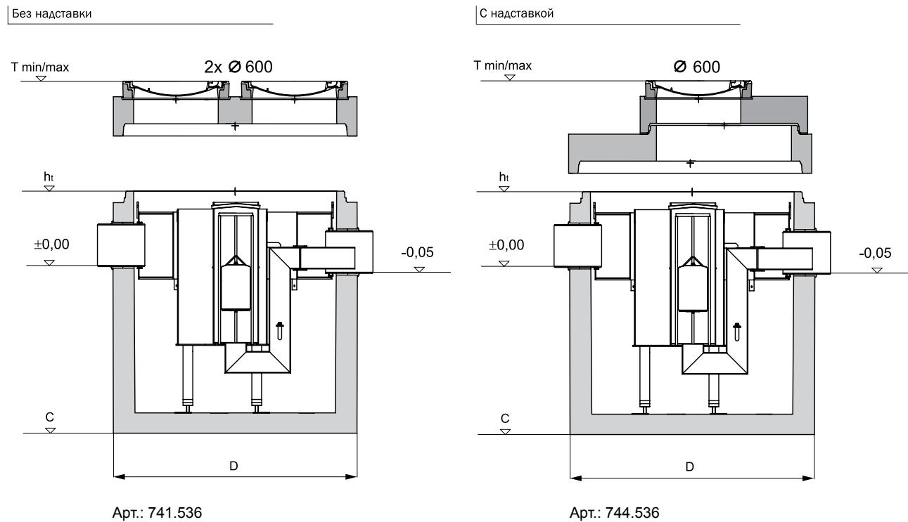
**Tmin** – минимальная глубина установки сепаратора по лотку трубы
