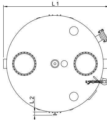
На изображении показан сепаратор номиналом 7л/с, обслуживаемый справа. При левостороннем обслуживании все элементы будут расположены в зеркальном отражении.
