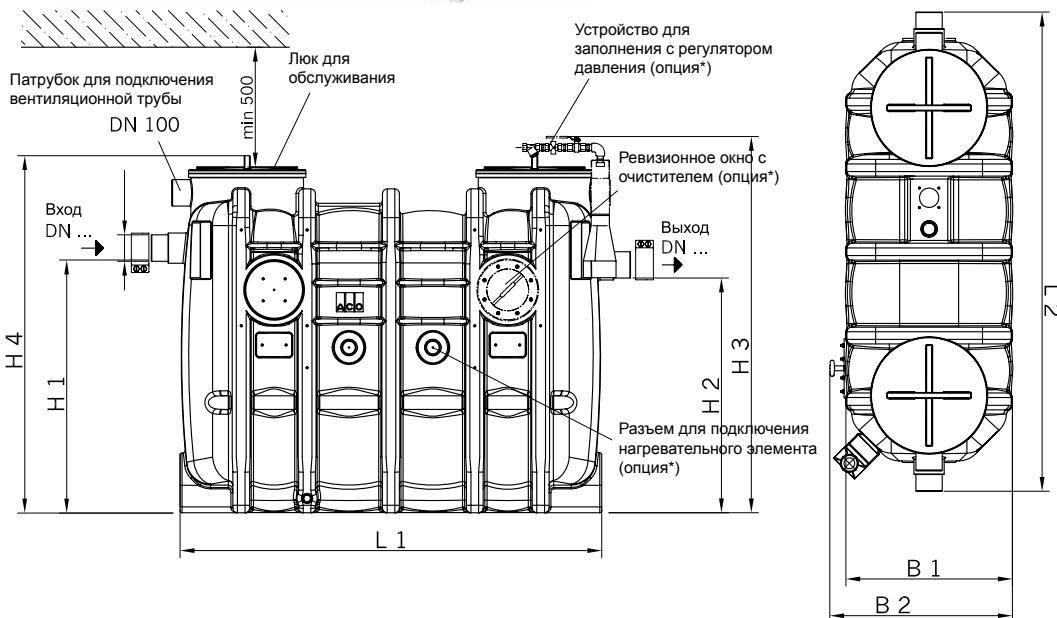
На изображении показан сепаратор номиналом 4л/с, обслуживаемый справа. При левостороннем обслуживании все элементы будут расположены в зеркальном отражении.
