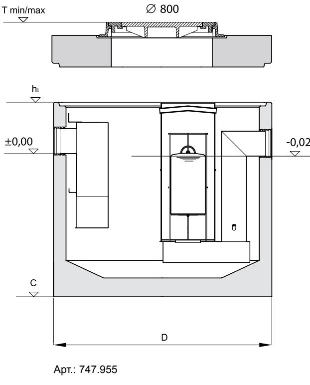
T<sub>min</sub> – минимальная глубина установки сепаратора по лотку трубы
