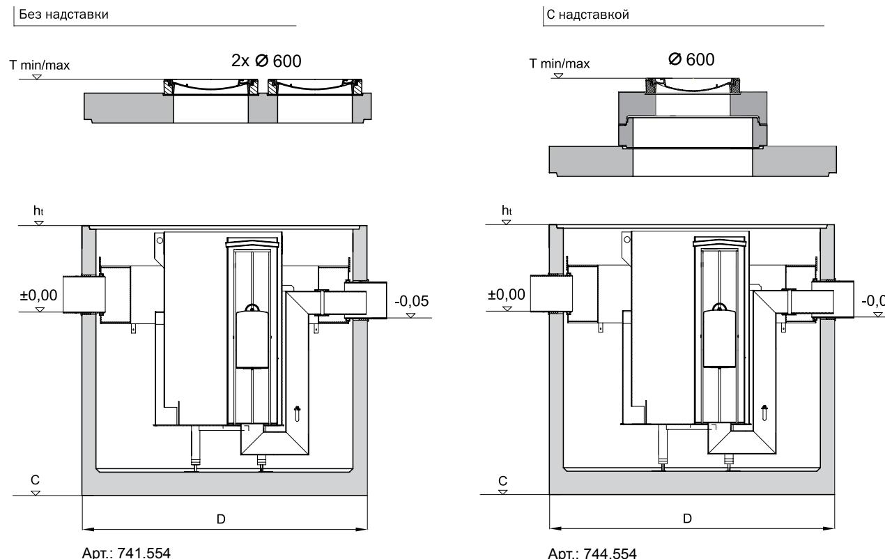
**T<sub>min</sub>** – минимальная глубина установки сепаратора по лотку трубы
