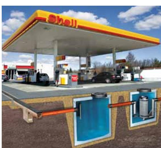
Пример инженерного решения для очистки дождевых вод для АЗС.
