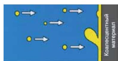
Крупные частицы нефтепродуктов преодолевают силу притяжения и силу, созданную движением потока воды и стремятся на поверхность, образуя пленку. Более мелкие частицы не могут преодолеть эти силы и стремятся с потоком сточных вод к выходному отверстию. Их путь преграждает поверхность коалесцентного фильтра.
