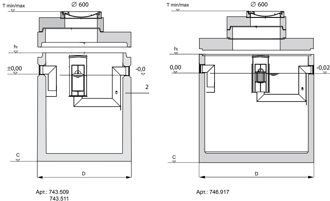
**T<sub>min</sub>** – минимальная глубина установки сепаратора по лотку трубы
