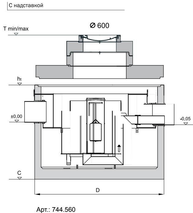
$T_{min}$  – минимальная глубина установки сепаратора по лотку трубы
