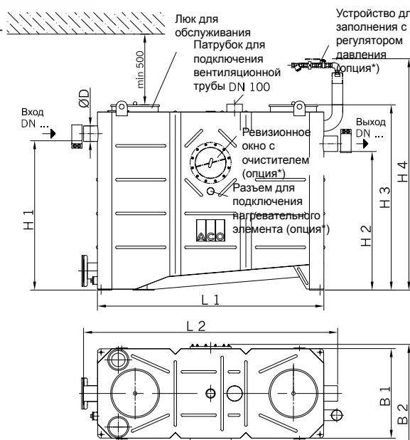
На изображении показан сепаратор номиналом 4л/с, обслуживаемый справа. При левостороннем обслуживании все элементы будут расположены в зеркальном отражении.
