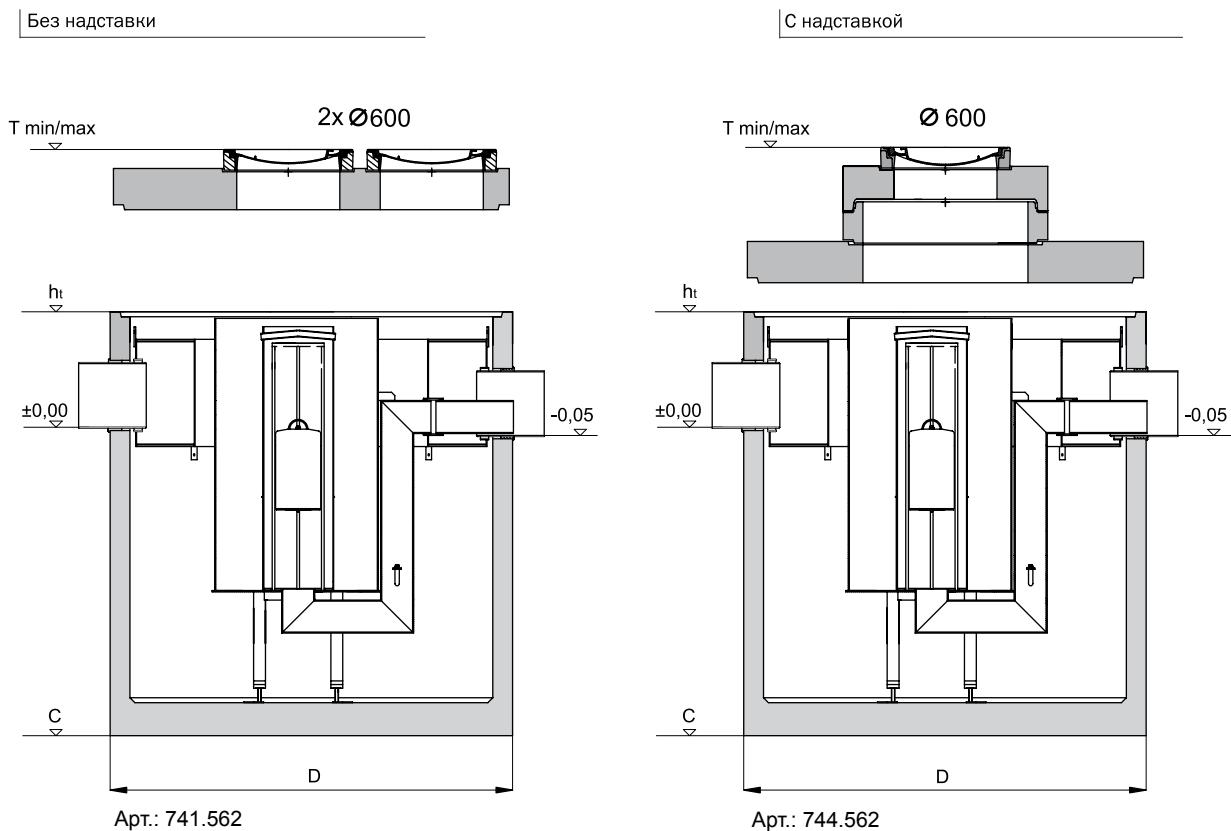
**T<sub>min</sub>** – минимальная глубина установки сепаратора по лотку трубы
