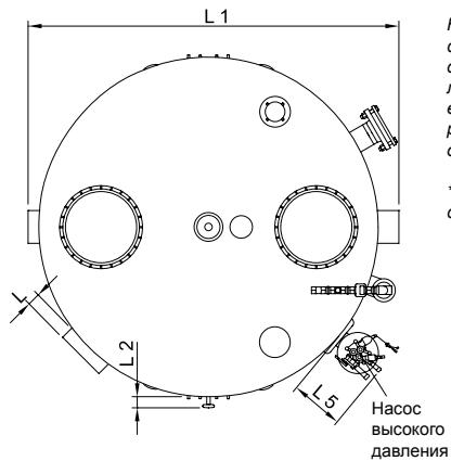
На изображении показан сепаратор номиналом 7л/с, обслуживаемый справа. При левостороннем обслуживании все элементы будут расположены в зеркальном отражении.
