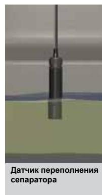
Датчик переполнения сепаратора
