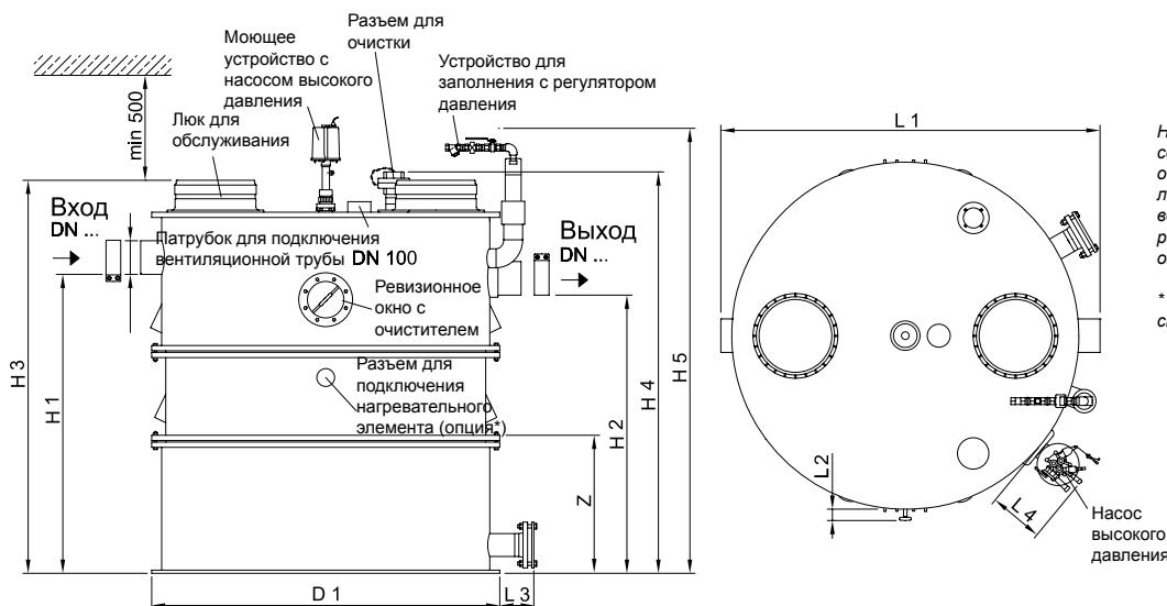
На изображении показан сепаратор номиналом 7л/с, обслуживаемый справа. При левостороннем обслуживании все элементы будут расположены в зеркальном отражении.
