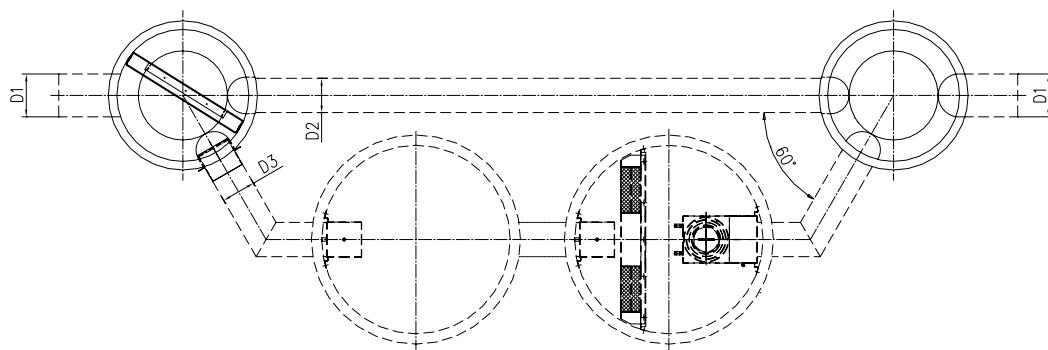
Схема параллельного подключения сепаратора (в плане)
