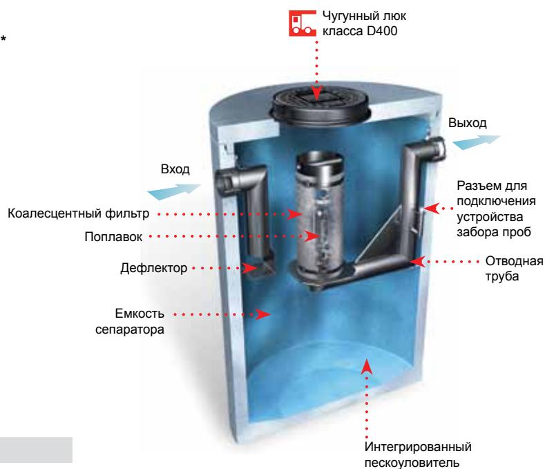
\*- Сепараторы Oleopator®-K используются с внешней обводной веткой (By-PASS). Подробнее смотрите схемы монтажа на стр.46-48
