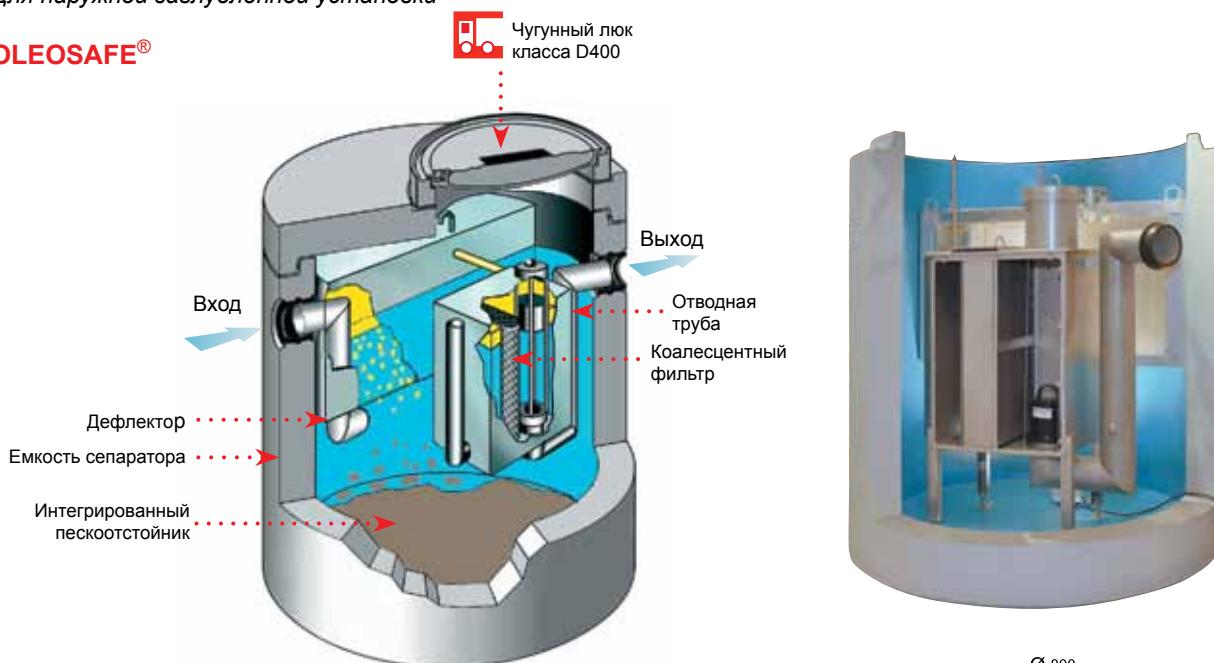
Сепаратор нефтепродуктов ACO Oleosafe® – продукт лидера европейского рынка по системам водоотвода и водоочистки. Следуя в ногу со временем и заботясь о защите водных ресурсов планеты от загрязнения, компания ACO создала сепаратор, который очистит поверхностные воды от нефтепродуктов и защитит окружающую среду в случае наводнений, повышения уровня поверхности и грунтовых вод во время экстремальных дождей и т.п.
