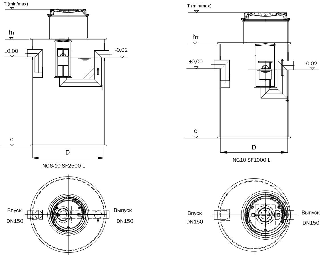
$T_{min}$  – минимальная глубина установки сепаратора по лотку трубы
